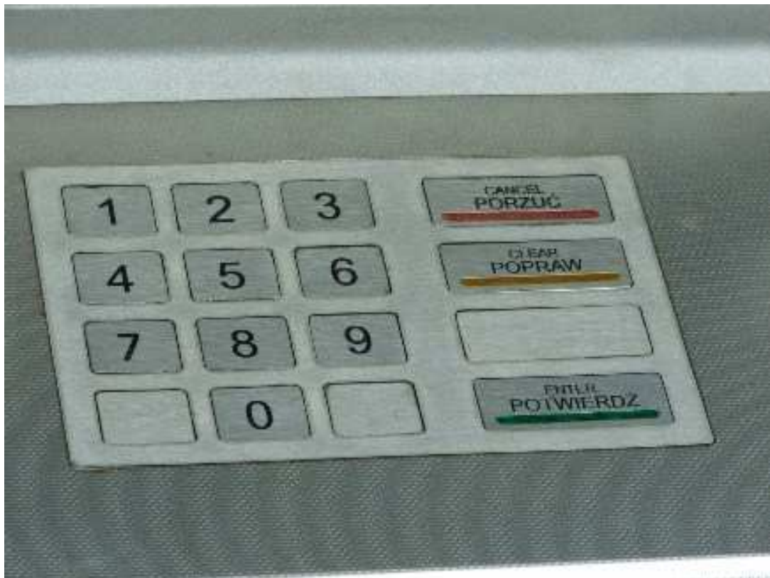
Rys. 6 Nakładka na klawiaturę (Źródło: materiały własne KWP we Wrocławiu)
