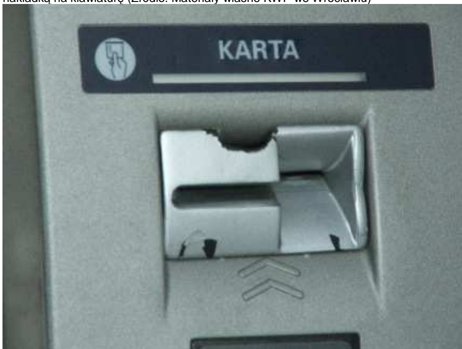
Rys. 10 Nakładka na bankomat zawierająca urządzenie skimmujące umieszczone na wlocie na karty (Źródło: Materiały własne KWP we Wrocławiu)
