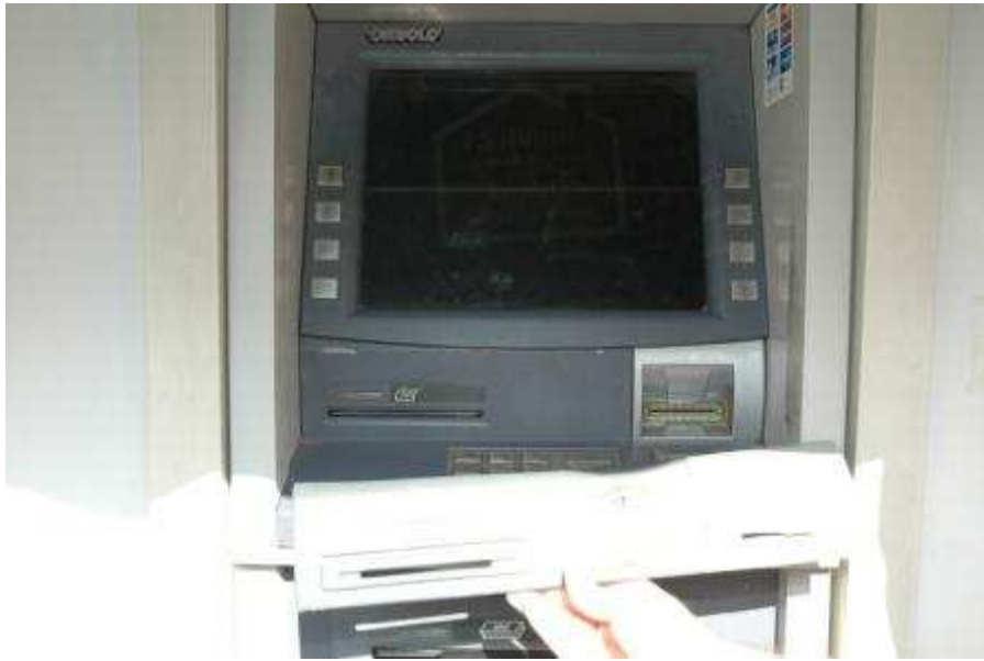
Rys. 4 Bankomat po ściągnięciu nakładki (Źródło: materiały własne KWP we Wrocławiu)
