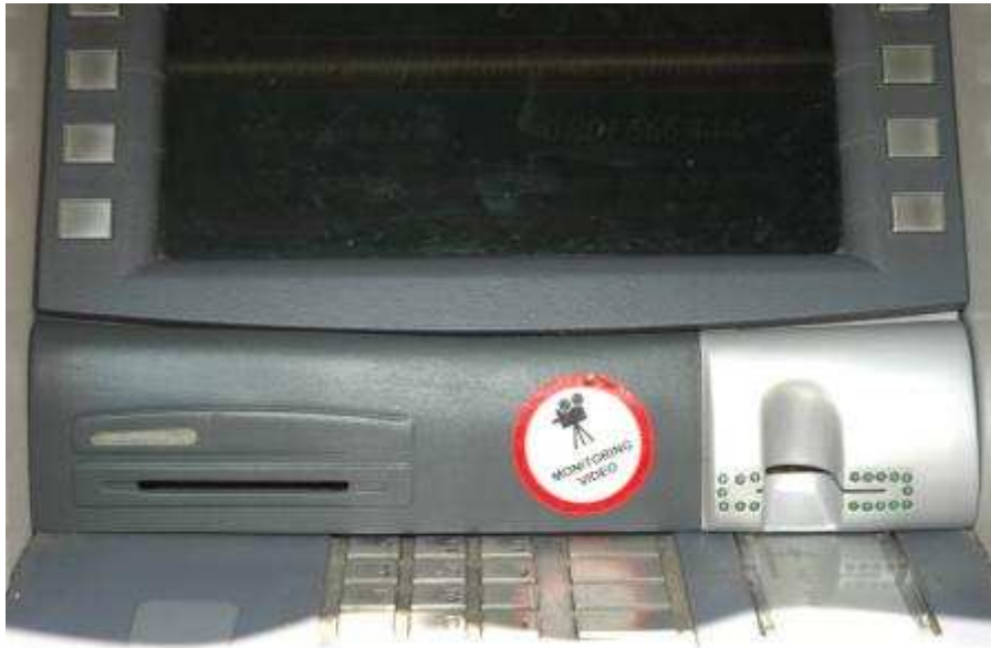
Rys. 2 Nakładka na bankomat zawierająca urządzenie skimmujące umieszczone na wlocie na karty wraz z kamerą skierowaną na klawiaturę (Źródło: materiały własne KWP we Wrocławiu)
