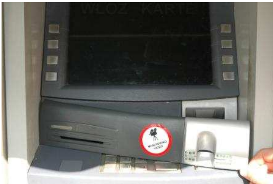
Rys. 3 Demontaż nakładki (Źródło: materiały własne KWP we Wrocławiu)
