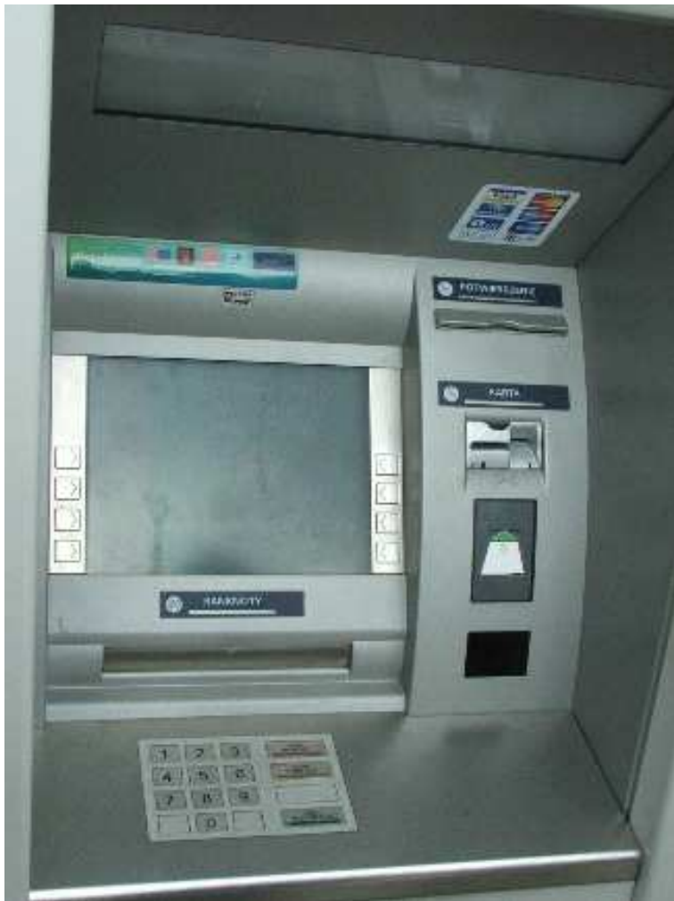
Rys. 9 Nakładka na bankomat zawierająca urządzenie skimmujące umieszczone na wlocie na karty wraz z nakładką na klawiaturę (Źródło: Materiały własne KWP we Wrocławiu)
